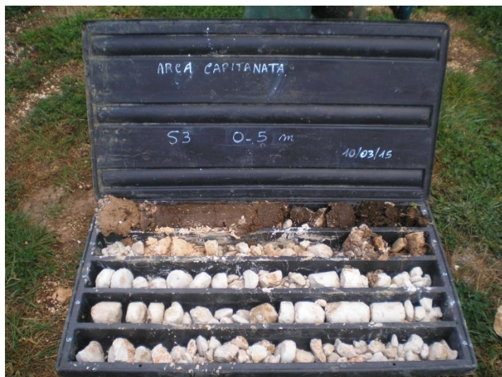
Foto 11: cassetta catalogatrice 0-5 metri
