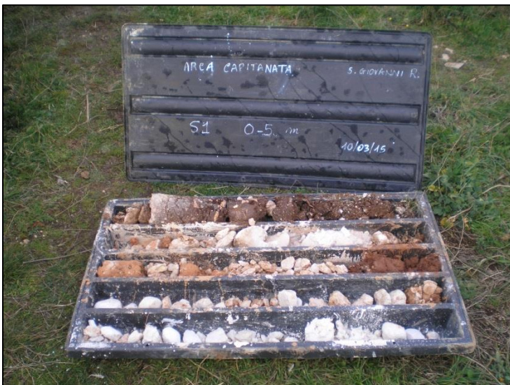
Foto 3: cassetta catalogatrice 0-5 metri
