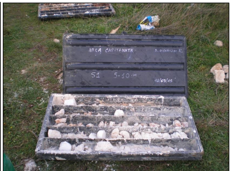
Foto 4: cassetta catalogatrice 5-10 metri
